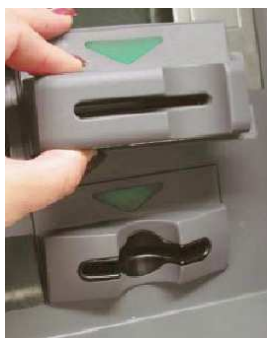
Obrázek 2: Kryt s falešnou čtečkou.
